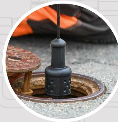
Es gibt verschiedene Möglichkeiten, Rohrbrüche auffindig zu machen. Über Nacht werden sogenannte Geräuschlogger eingesetzt, die alles aufzeichnen, was sie im Netz vernehmen. »Wasser hört man.« Am Morgen werden die Geräte wieder entfernt, die Aufnahmen ausgewertet.
