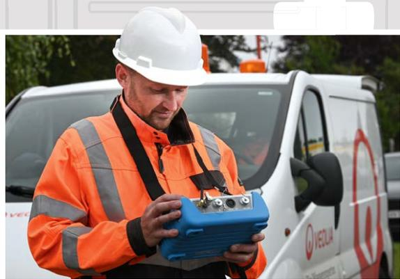
Mit dem Bodenmikrofon registriert Fred Voigtländer, der aus der Oschatzer Ecke stammt, inzwischen mit seiner Familie aber in Bad Lausick lebt, Fließgeräusche und arbeitet sich Schritt für Schritt bis zum Leck vor. »Je genauer wir wissen, wo der Rohrbruch ist, desto geringer ist der Aufwand für den Tiefbau«, weiß er und betont, dass das Hauptanliegen der Leckortung ist, Wasserverluste möglichst auf niedrigem Niveau zu halten.
